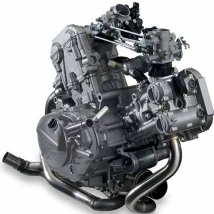
Silnik 645 cm 3 DOHC, 90° V-Twin
