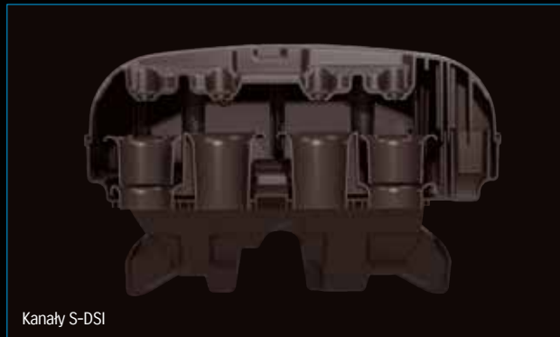
Obudowa filtra powietrza i przepustnice
