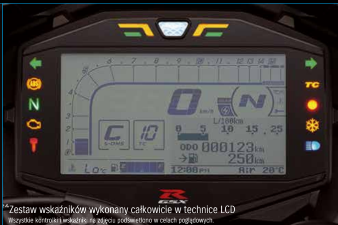
Zestaw wskaźników wykonany całkowicie w technice LCD Wszystkie kontrolki i wskaźniki na zdjęciu podświetlono w celach poglądowych.
